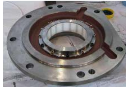
Die Drehmomentsensorik ist in einen Lagerdeckel eines Getriebes integriert. Somit kann sie Bauraum sparend im Getriebe eingesetzt werden.
