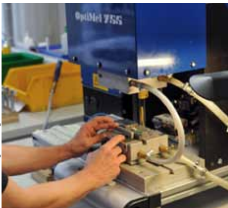
Die Elektronik der Drehmomentsensorik wird in eine Macromelt-Hülse vergossen.
