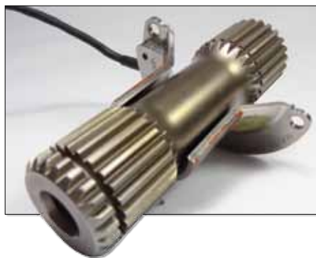
Berührungslose Messung: Die Welle liegt im „Halbschalen-Sensor“. In der Halbschale sind Messspulen integriert; sie nehmen die Magnetfeldänderung ab. Der Abstand des Sensors zum Spulenhalter kann bis zu 1 mm betragen
